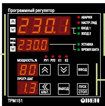
Элементы индикации и управления приведены для двухканального регулятора TRM151-01, для TRM151 других модификаций они могут иметь небольшие отличия.
