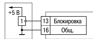
Устройство, имеющее на выходе сигнал TTL-уровня
