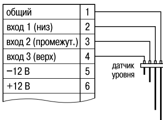
Схема подключения кондуктометрических датчиков уровня
