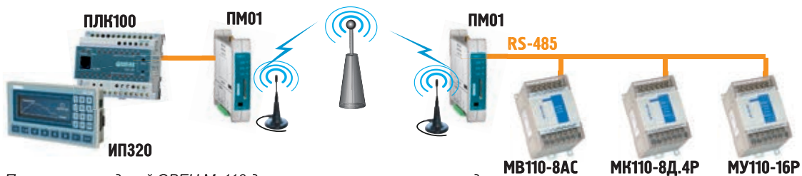
Применение модулей ОВЕН Мх110 для построения систем распределенного управления на базе управляющего контроллера ПЛК100
