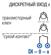
Схема подключения дискретных входов ПЛК100
