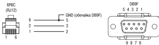
Кабель КС2 для подключения ПЛК100 к панелям ИП320, СП270 и СП3xx (порт RS-232 Debug)
