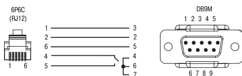
Схема кабеля КС3 «ПЛК-Модем»
