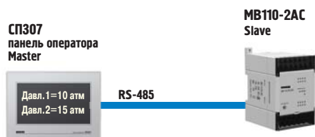
Подключение модулей Мх110 к панели оператора СП307
