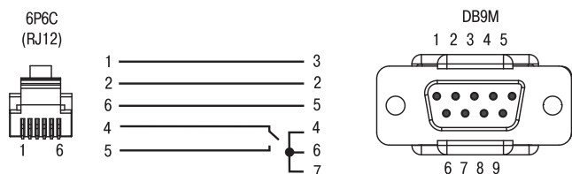
Схема кабеля КС3 для подключения модема к ПЛК100 по интерфейсу RS-232
