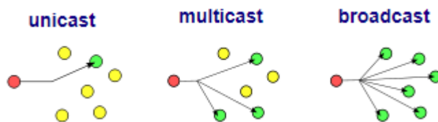
Рисунок 2.1 – Схемы маршрутизации UDP
