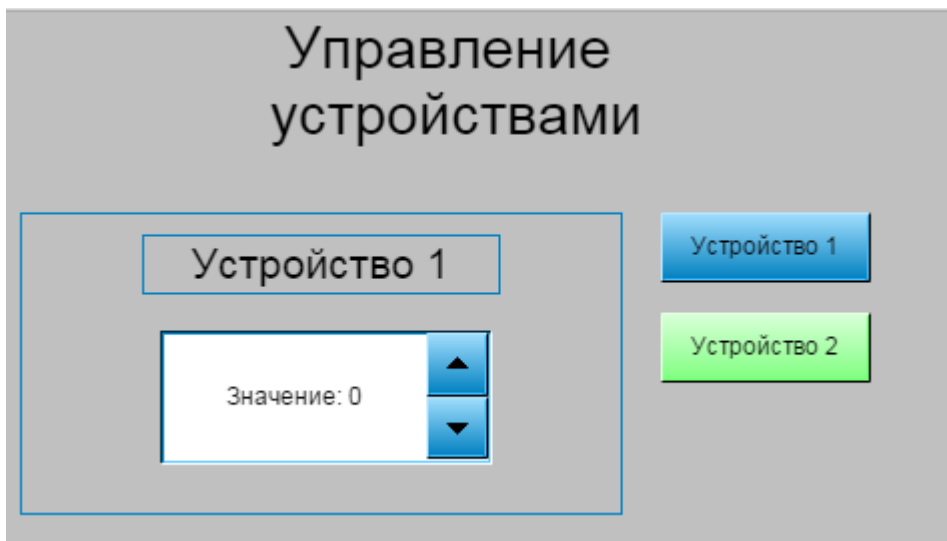
Рисунок 10.469 – Выделенная кнопка не соответствует отображаемому устройству
